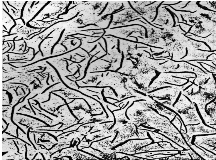
Figure-12: Microstructure typique d'une fonte à graphite lamellaire Attaquée au Picral à 4% × 100 [15].
