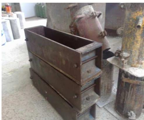
**Les moules cubique de traction par flexion**
