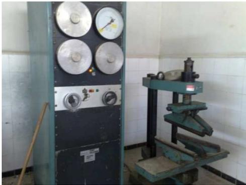
**Photo 4.6 : Machine automatique de flexion.**
