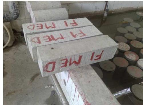
**Photo 4.7 : Eprouvettes de traction par flexion.**
