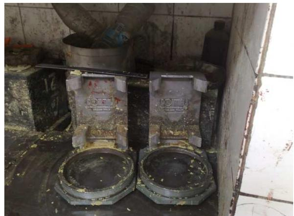
**L'appareille de surfaçage des moules**
