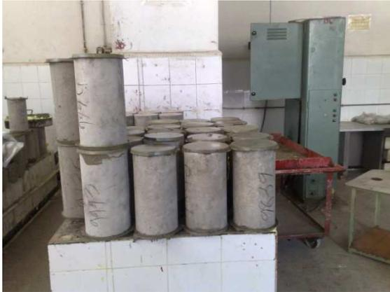
*Photo 4.4 : Eprouvettes surfacés.*
