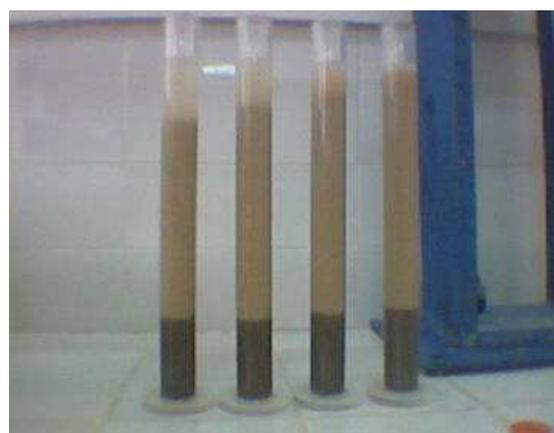
**Essai de l'équivalent de sable**
