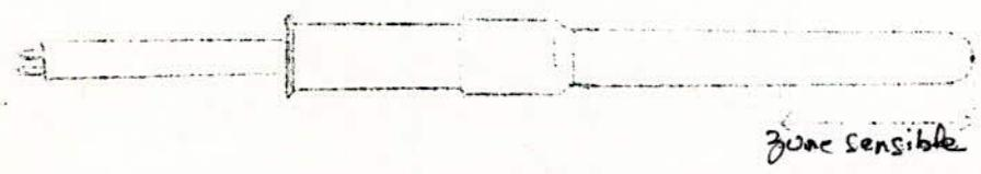
La partie sensible contient une sonde à résistance de platine (conforme à la norme DIN 43760) utilisable de  $-200^{\circ}\text{C}$  à  $+500^{\circ}\text{C}$
