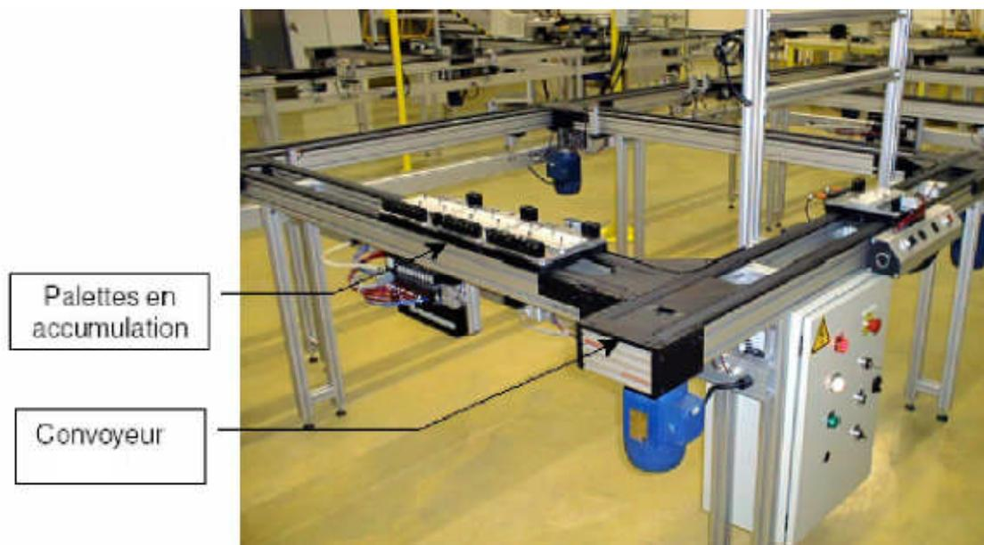
Figure I.6 : Convoyeur avec accumulation (Ghazi, 2007).
