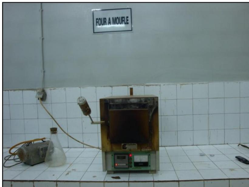
**Figure VI-8** : photos du four à moufle utilisé.
