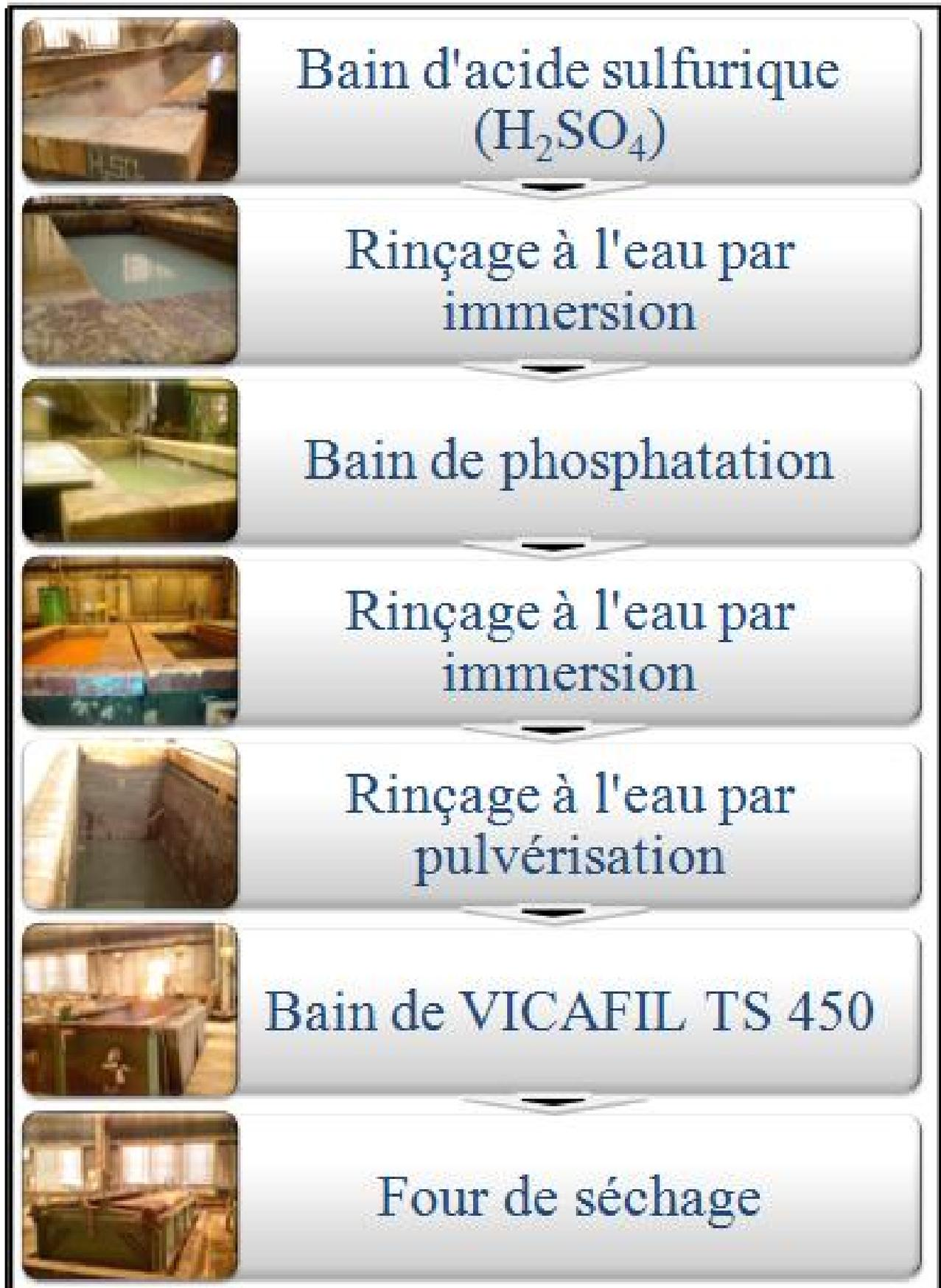
**Figure V-5 :** Schéma présentant des photos sur le processus de décapage chimique et de phosphatation.
