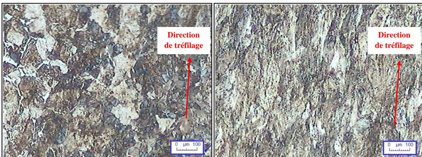
**Figure VII-2** : microstructure du fil tréfilé avec un taux de déformation  $\varepsilon=0,20$  (coupe en long), X 200.
