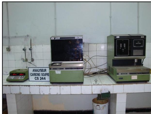
**Figure V-2** : Photo de l'analyseur carbone/ soufre utilisé.
