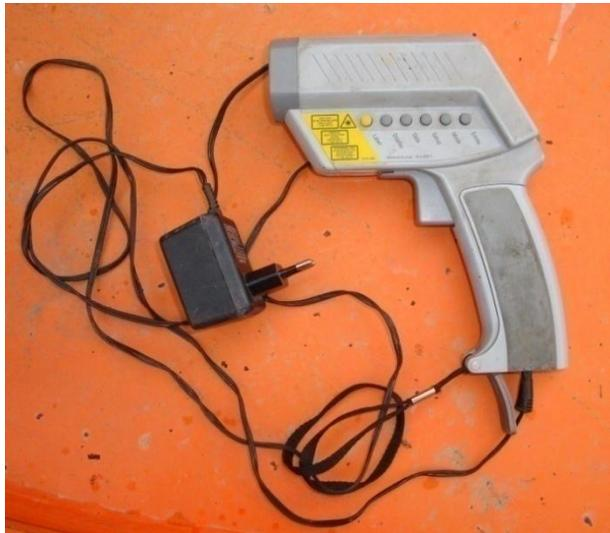
**Figure VI-3** : photo du pyromètre utilisé.
