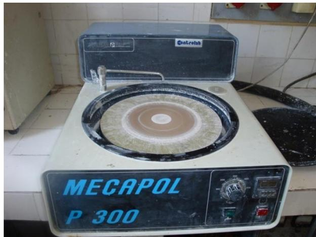
**Figure VI-5 :** photo de la polisseuse utilisée pour le polissage de finition.
