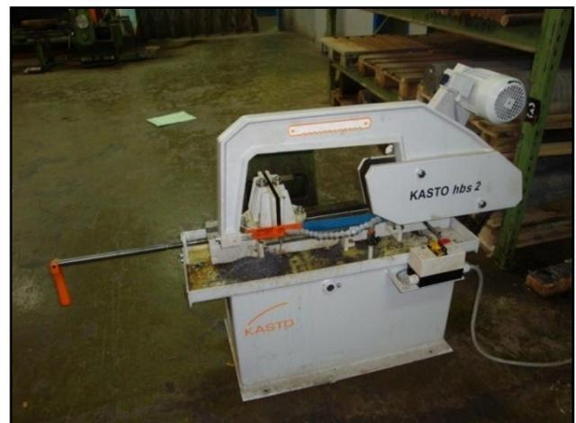
**Figure VI-2** : Photo de la scie mécanique utilisée.
