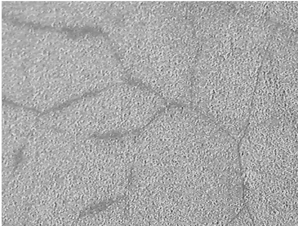
Figure IV.15. Surface de dépôt de chrome après 100 cycles.
