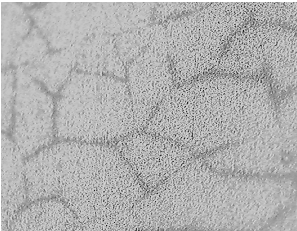
Figure IV.16. Surface de dépôt de chrome après 150 cycles.
