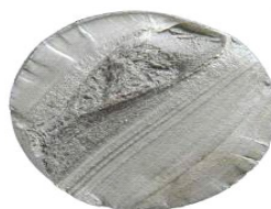
Figure I.8 : Arbre rompu en fatigue [1]
