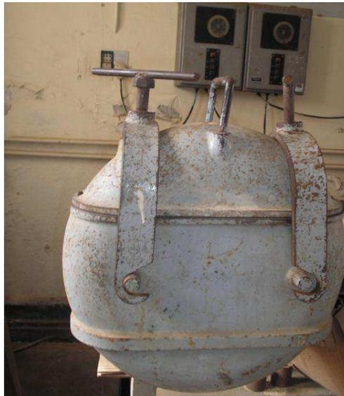
**Figure V.3.** Photo d'une chambre du broyeur à boulets utilisé.
