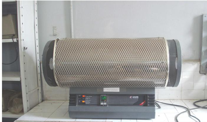
Figure V.5. Vue réelle du four tubulaire utilisé.
