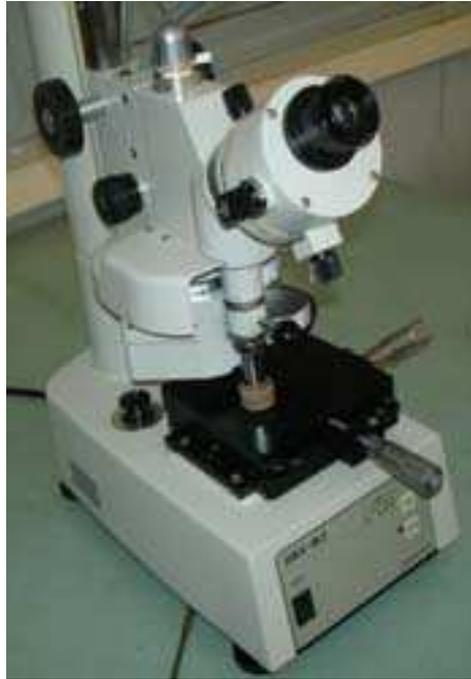
**Figure .V.9.** *Micro-duromètre SHIMATZU HMV-M3*
