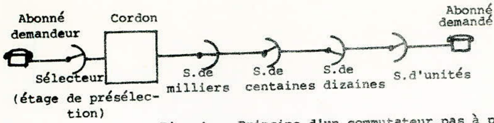
Fig. 4. Principe d'un commutateur pas à pas
