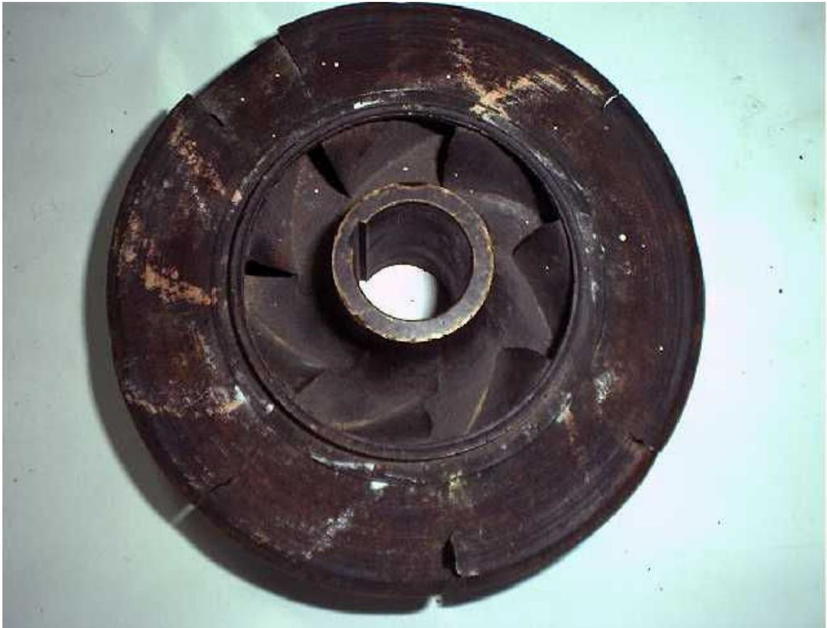
**PHOTO I.2** Roue fermée semi - axiale, endommagée par l'érosion d'abrasion
