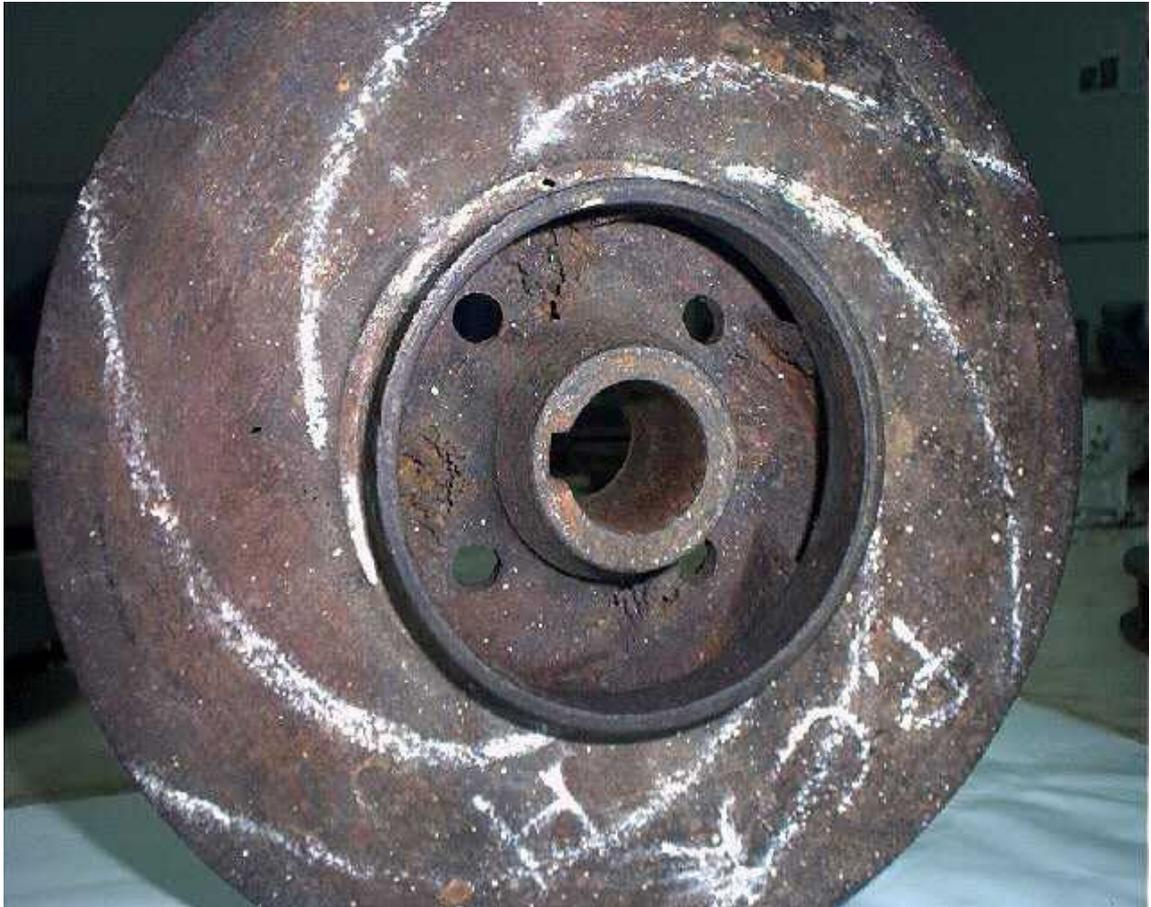
**PHOTO I.1** Roue fermée centrifuge, endommagée par l'érosion de cavitation
