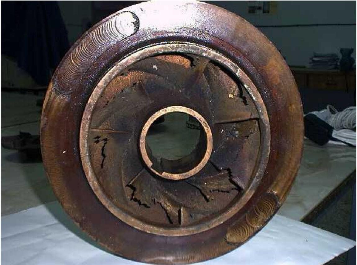
**PHOTO I.4** Roue fermée centrifuge d'une pompe multicellulaire à axe horizontal, endommagée par l'érosion de cavitation (cas d'une installation en charge )
