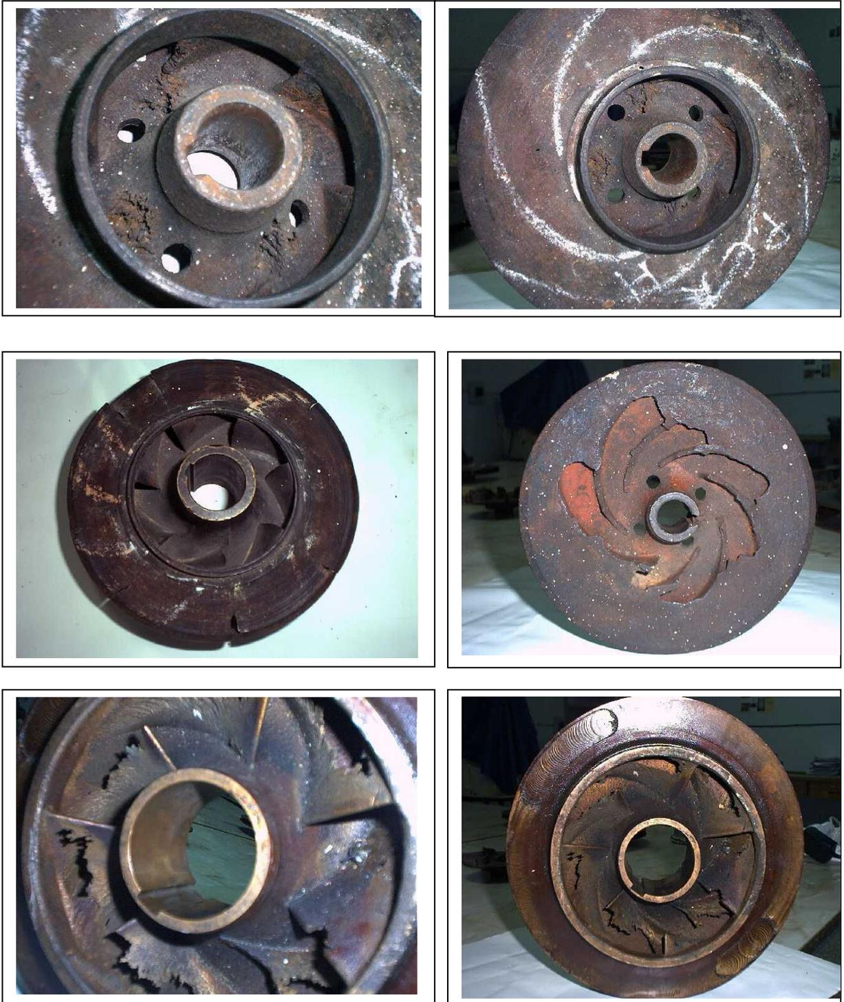
**Figure VI.6** Conséquences de l'érosion abrasive sur les roues
