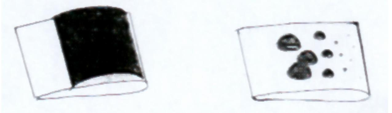
**Figure II.1 :** Cavitation par poche attachée, **Figure II.2 :** Cavitation par bulles séparées
