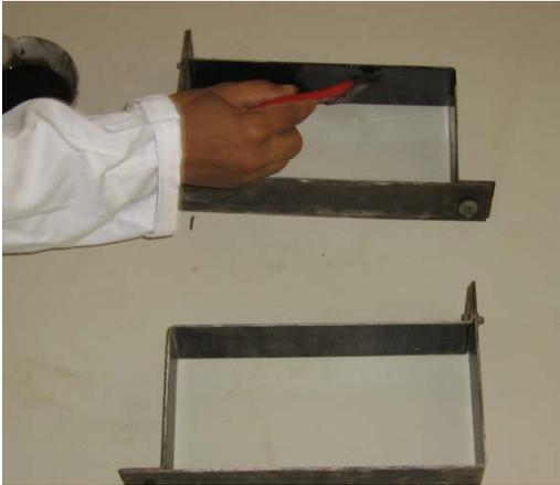
Photo 1 : Graissage des moules
