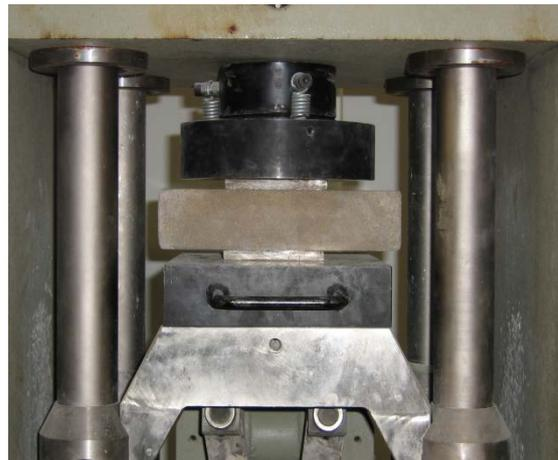
Photo 10 : Essai de résistance à la compression
