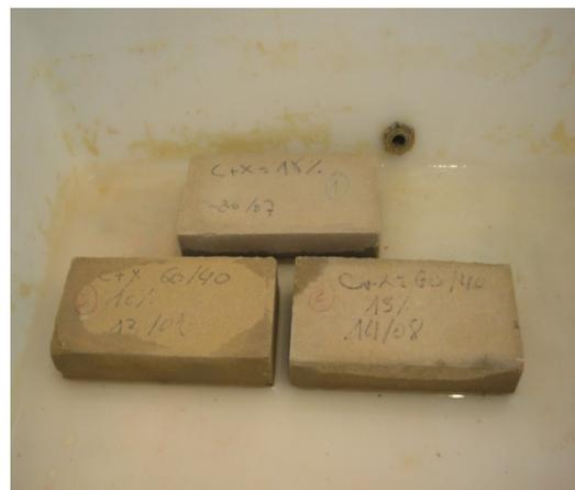
Photo 9 : Essais absorption d'eau par capillarité
