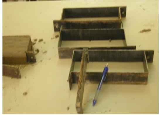
Photos 4 et 5 : Démoulage des briques et nettoyage des moules
