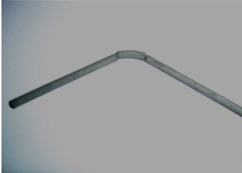
**Figure IV.13** : Essai de pliage d'un échantillon métallisé
