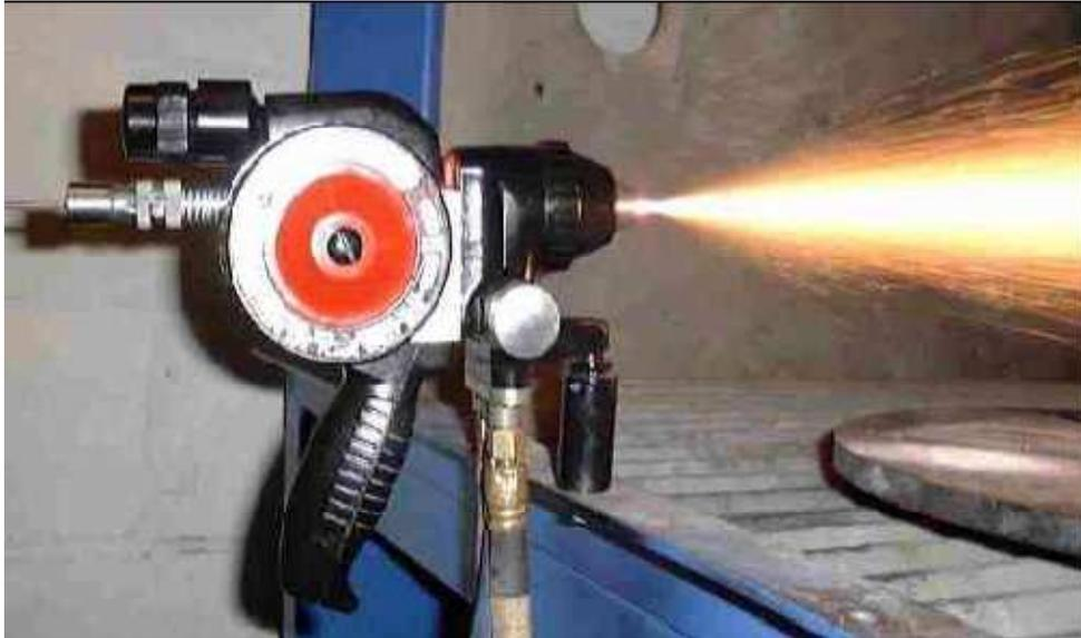
**Figure III.3** Pistolet de projection à arc électrique « Arc spray 234 » ayant servi à la projection de l'acier inoxydable 55<sup>E</sup> et du Ni-Al
