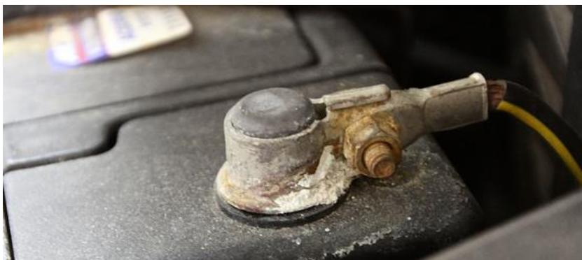
*Figure 2.1 : Sulfatation d'une borne de batterie*
