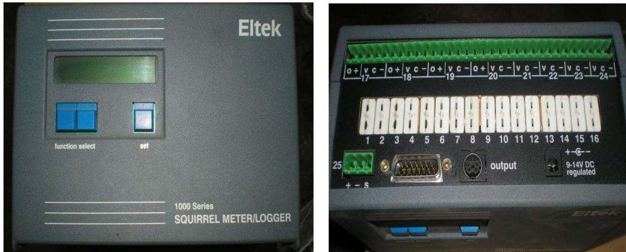
**Figure.20** système ELTEK d'acquisition des températures.
