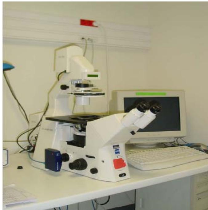
Figure.25 microscope optique Zeiss
