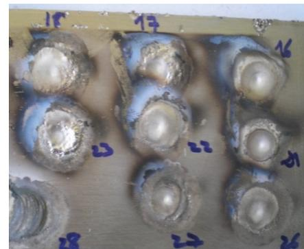
Pour une fréquence de 0.6 nous avons obtenu une meilleure stabilité de l'arc qu'avec des intensités supérieures à 90A qui ont donnés une meilleure fluidité et mouillage du bain de fusion. L'écart entre l'intensité du courant haut et bas diminue en fonction de l'augmentation de l'intensité est de l'ordre de 50% pour une intensité de 60 A et de l'ordre 40% pour une intensité de 110A.
