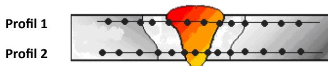
Figure.58 Schéma du balayage de la microdureté.
