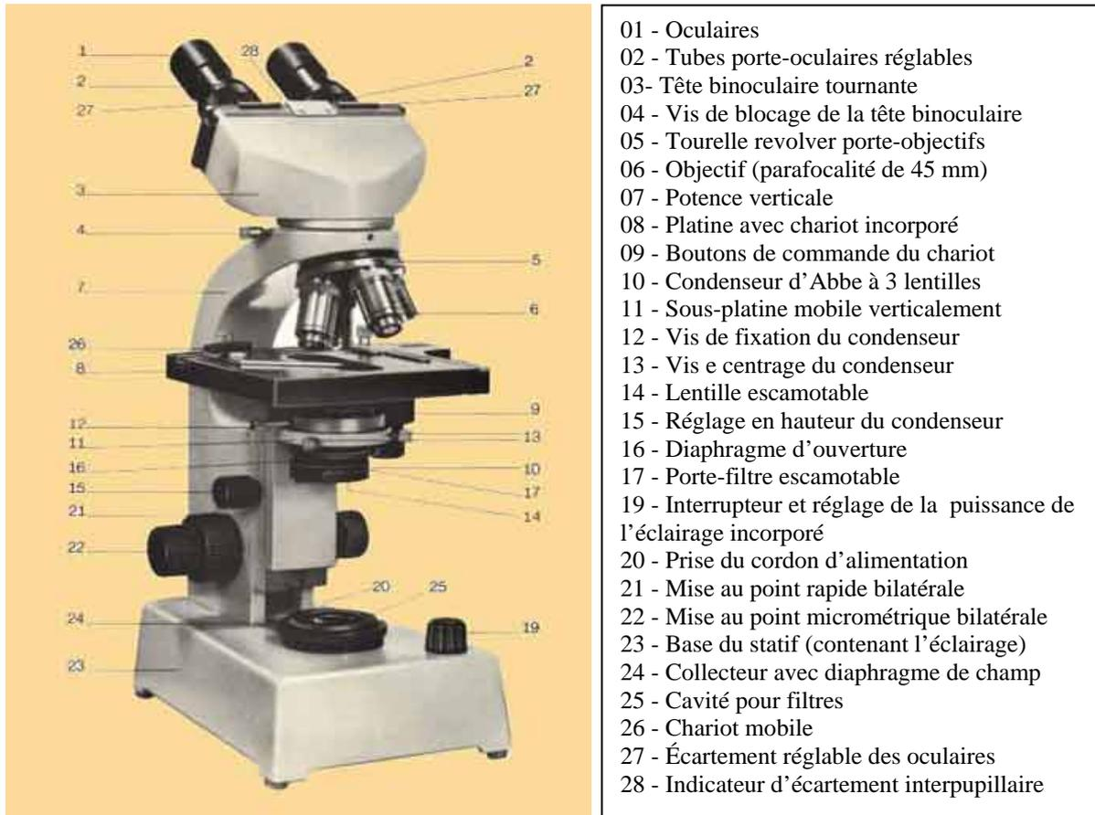
Figure.26 Les constituants d'un microscope optique.
