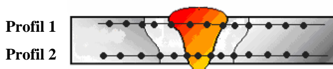
Figure-15- Schéma du balayage pour la mesure de la dureté sur le long d'un échantillon.
