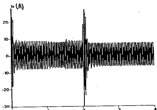
Figure.III.18.b. Le courant I_x transitoire et permanent de la phase X de la machine asynchrone triphasée.
