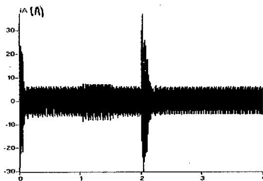
Figure.III.10.c. Le courant I_A transitoire et permanent de la phase A de la source triphasée.
