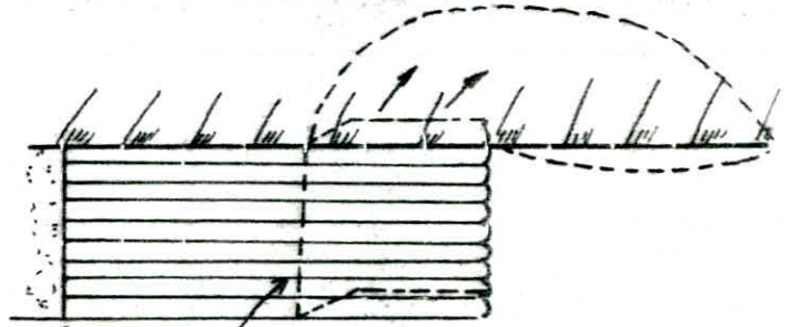
Fig 9 : rupture du sol de fondation par un mur à faible valeur de L/H
