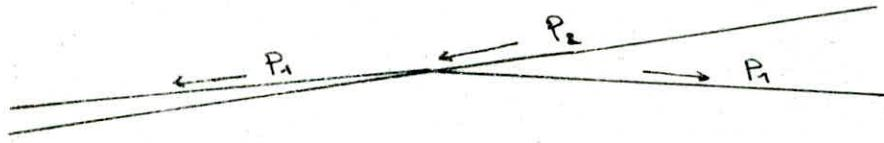
La pente transversale minimale requise ( $P_1$ ) pour des raisons d'assainissement est de l'ordre de 2,5%, la pente maximale dans les courbes circulaires est de 6%. Les pentes transversales requises dans les courbes circulaires à rayon différents sont à prélever dans le tableau des paramètres fondamentaux des pavés routiers en fonction de la vitesse de référence.
