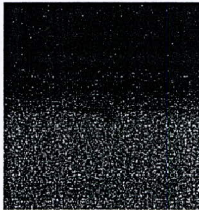
Figure IV-19 : photo MEB, représente la concentration du fer dans le substrat et dans la couche d'oxyde, analyse à partir des électrons secondaires d'un acier AISI 430 Ti , oxydé à 900°C sous 150 mbar d'O 2 .
