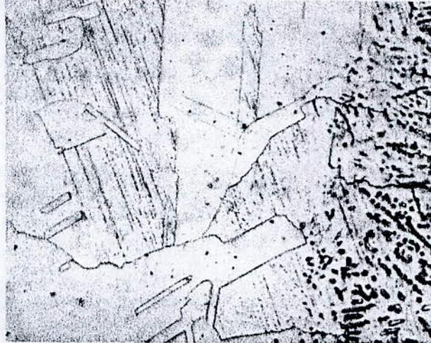
**Figure II.16** –Structure de la zone de liaison G  $\times$  200.
