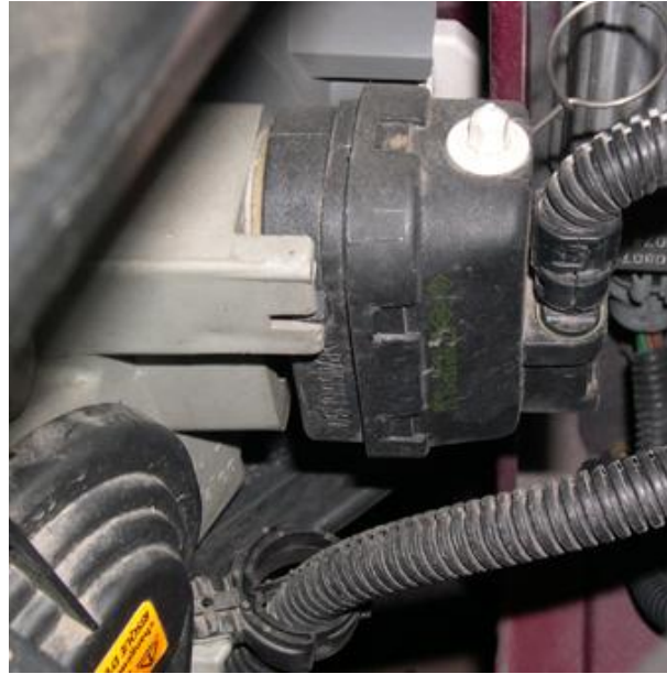
Fig. I.4 : correcteur de phare d'une Mégane II [8].
