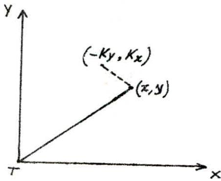
Si l'on désigne par  $I_x$  le moment d'inertie de la section du poteau par rapport à un axe parallel à  $T_x$  et  $I_y$ : le moment d'inertie par rapport à un axe parallel à  $T_y$ , les actions horizontales  $(-K_x, K_y)$ , et les moments par rapport à  $T$  sont  $KI_y \cdot y^2$ ,  $KI_x \cdot x^2$ .
