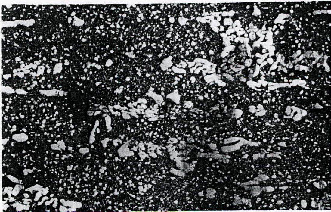
Fig. III.4 Structure de l'acier Z 160CDV 12 à l'état de référence. Zone marginale (x500 )
