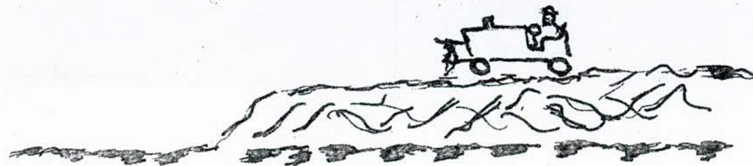
2-2) Le compactage le plus accentué, recherché systématiquement, obtenu non seulement par les engins de mise en place, mais par l'action des engins spéciaux de type "pied de mouton" dont le rôle est uniquement de renforcer le compactage. Les engins spéciaux interviennent au fur et à mesure des arrivages pour obtenir un tassement d'autant plus efficace que les couches successives sont plus minces.
