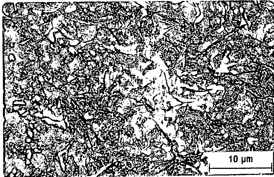
Fig III-13 : Fonte Ft 25, épaisseur 20 mm. Brut de coulée, avec attaque. Forme I, répartition A, dimension 3.
