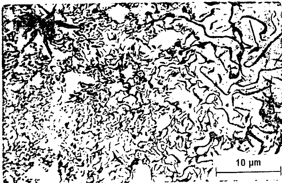
Fig III-17 : Fonte Ft 25, épaisseur 10 mm . Brut de coulée, sans attaque. Forme I-II, répartition A-B, dimension 5-4.
