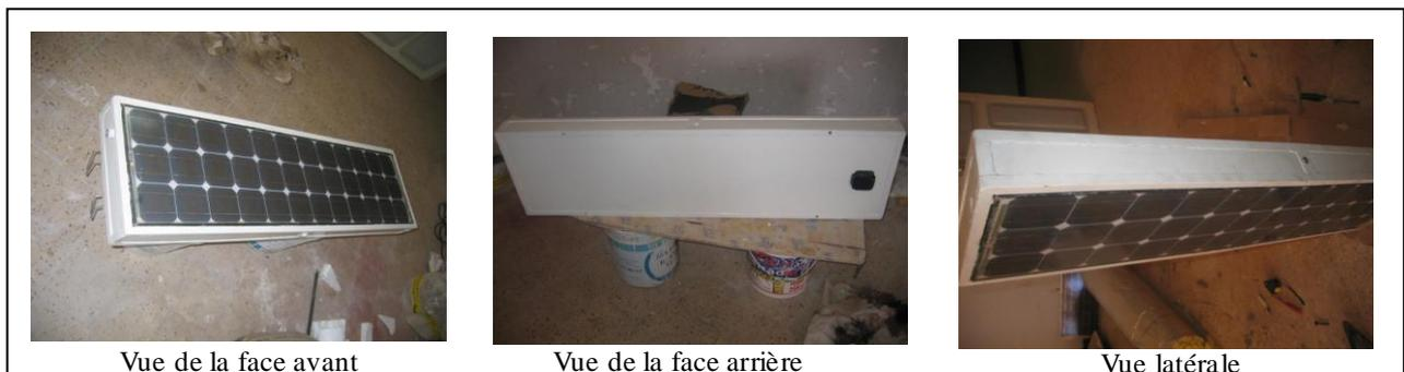
Figure 3.37 : Photo du prototype du nouveau capteur PVTnew réalisé
