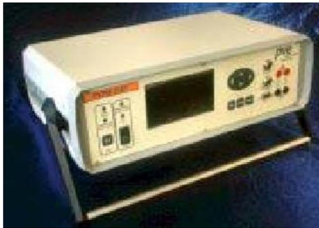
Figure 4.17 : Testeur de modules photovoltaïques PVPM
