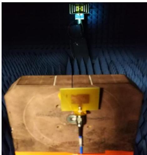
Figure II.14 Procédé de mesure du diagramme de rayonnement en chambre anéchoïque.
