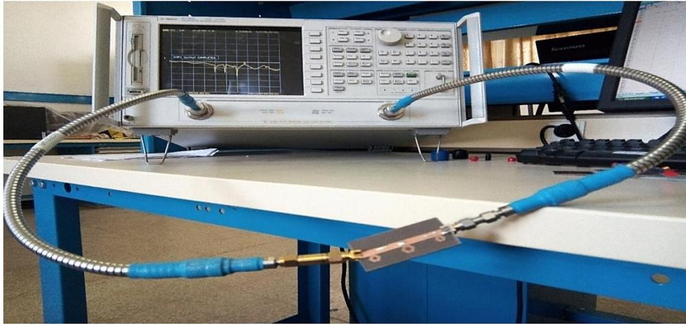
Figure III.24 Procédure de la mesure des paramètres S par analyseur de réseau.
