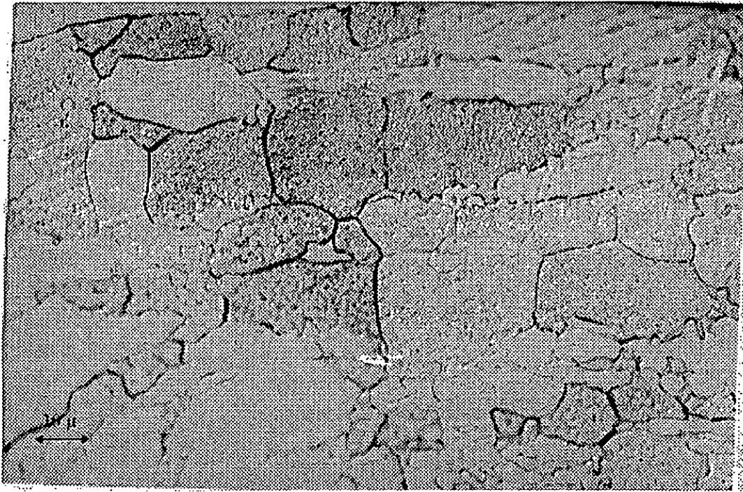
Figure n°14 : microstructure de l'acier forgé n°4 attaqué pendant 45 s par le réactif Kalling n°1 ( structure austéno-ferritique ). Grossissement G=1000
