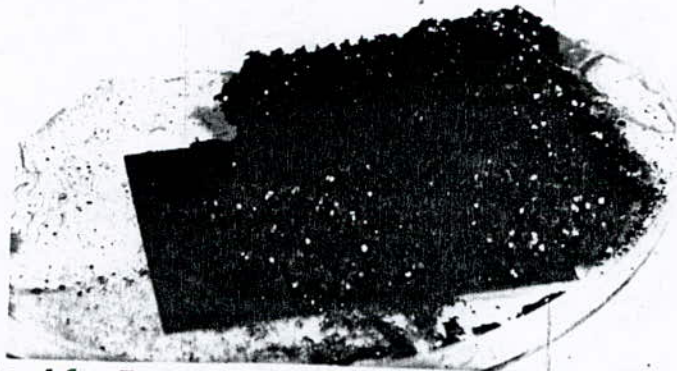
Fig.16: Forme de la poudre pour concentration de 20\text{g/l ZnO} ( i=1000\text{A/m}^2 , T=40^\circ\text{C} )
