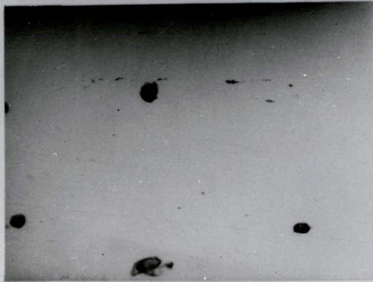
fig.4.1.i - inclusions dans le M.B à 40mm de la Z.F. (x500).
