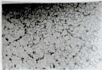
Fig.2 : Microstructure avec une ferrite à grains entrelimités et une perlite déposée aux joints de grains (E2) Taille moyenne des grains =  $6,6\mu$  .
