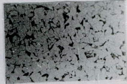
Fig.8: Micrographie comportant une ferrite
