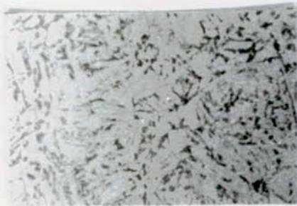
Fig.3 : Microstructure de la ferrite de Widmanstätten et des gros grains de ferrite allongés, légèrement en colonne. (E 3).
