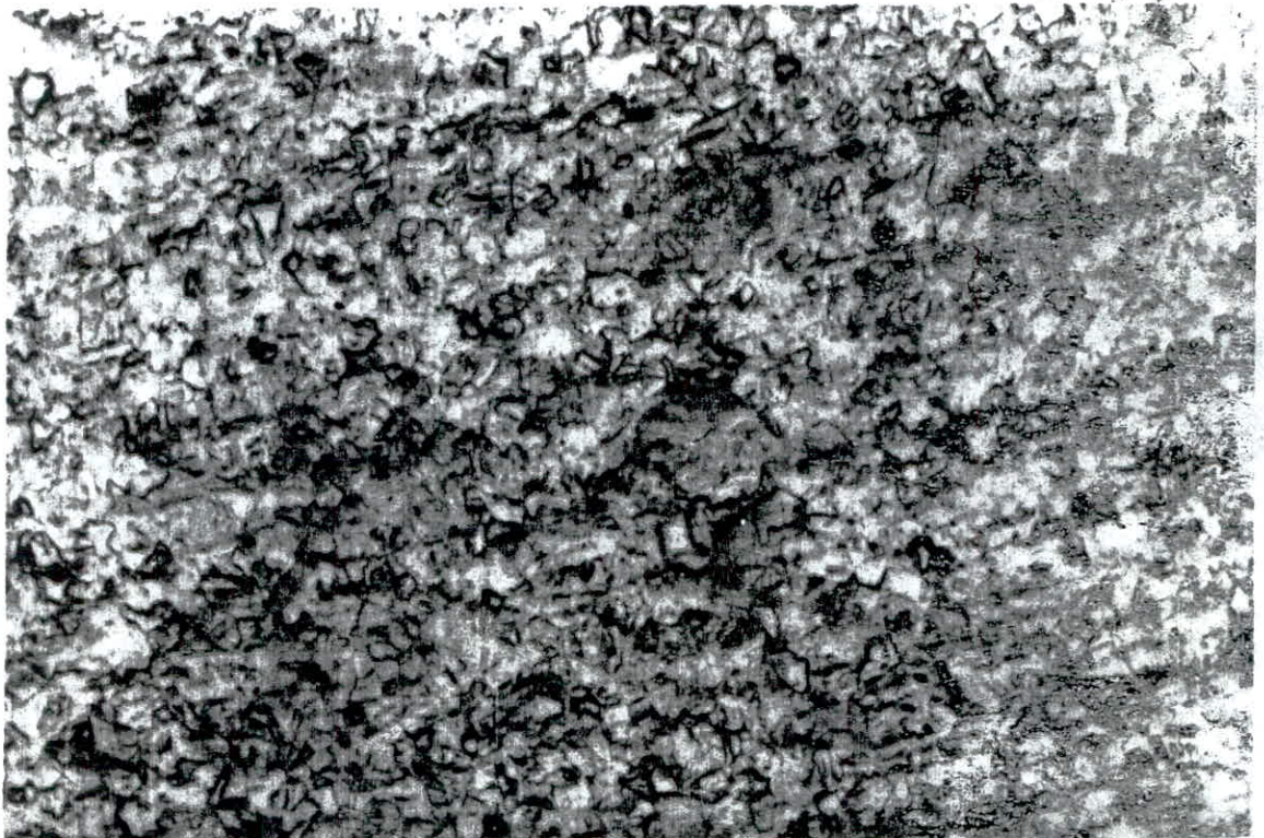
Fig 30 : Cu-Ni recuit à T=720^{\circ}\text{C} et t=30\text{min} ( \times 200 )
