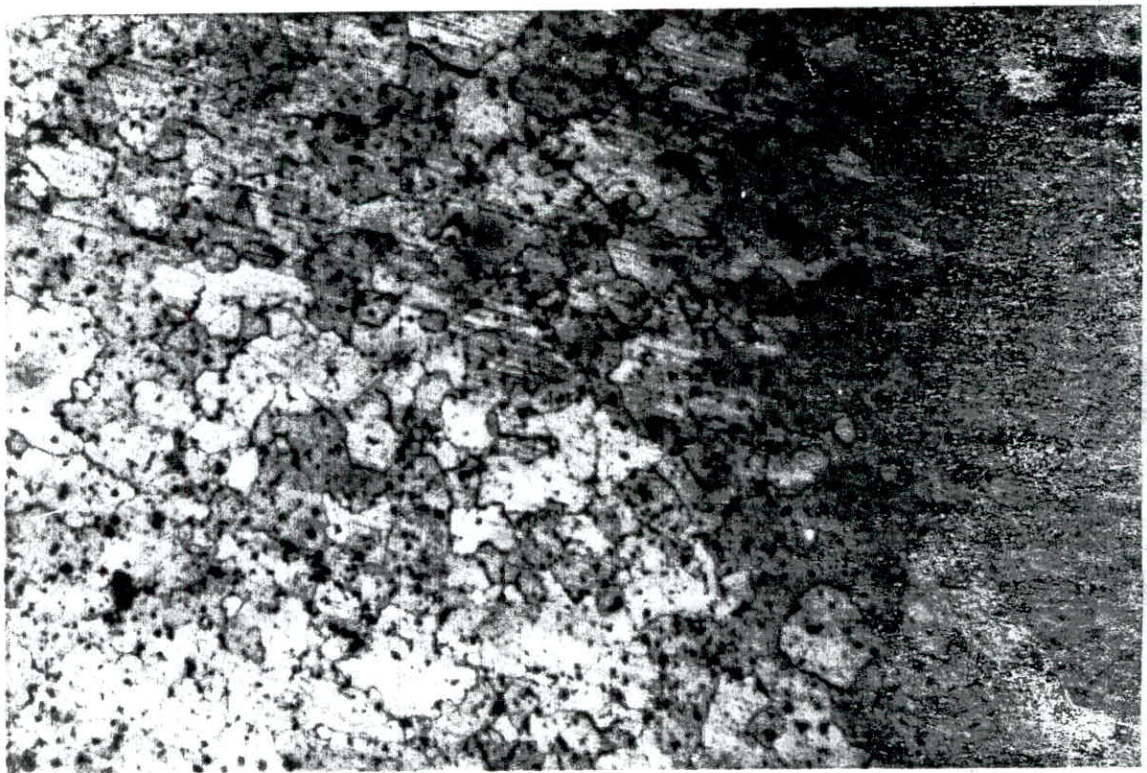
Fig 48 : acier inox recuit à T=850^{\circ}\text{C} et t=30\text{min} ( \times 200 )
