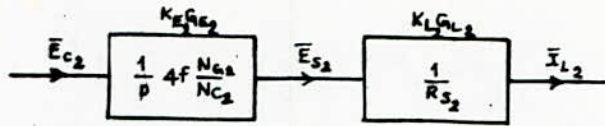
Fig. IV.1. — schéma fonctionnel de la fonction de transfert directe K_E G_E + fonction de transfert d'a charge résistive K_L G_L .
