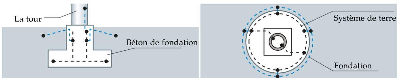
Figure 4.6 – Système de terminaison de terre d'une éolienne [154]
