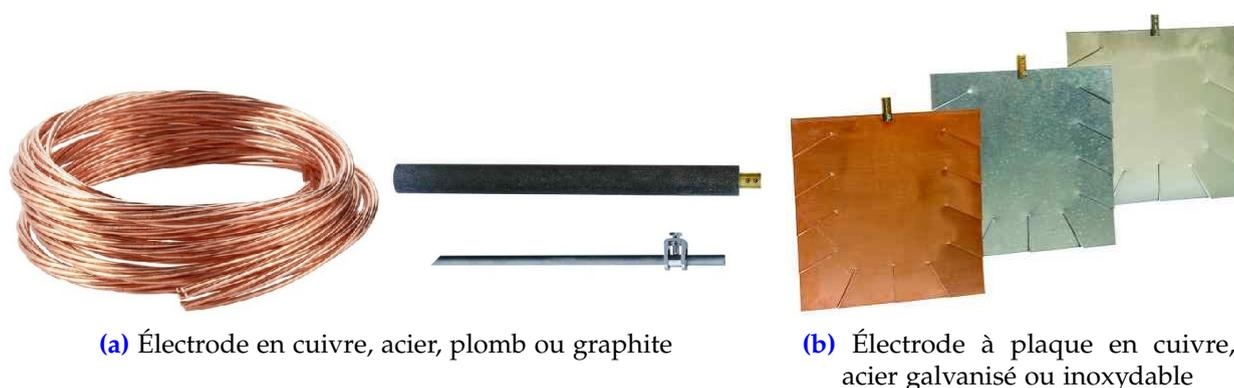
**Figure 1.11** – Principaux matériaux utilisés dans la conception des SMLT [44]
