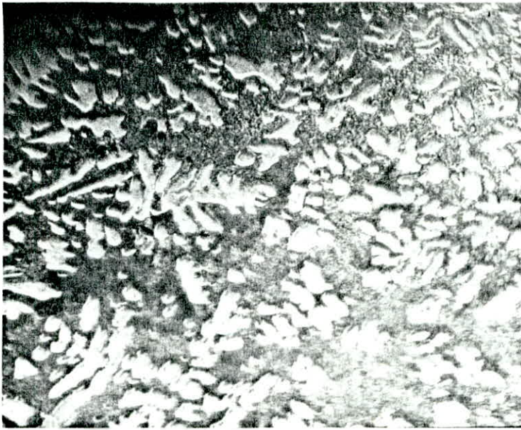
fig 15-a. Zamak : 3 - Trempé à eau (G=100)
