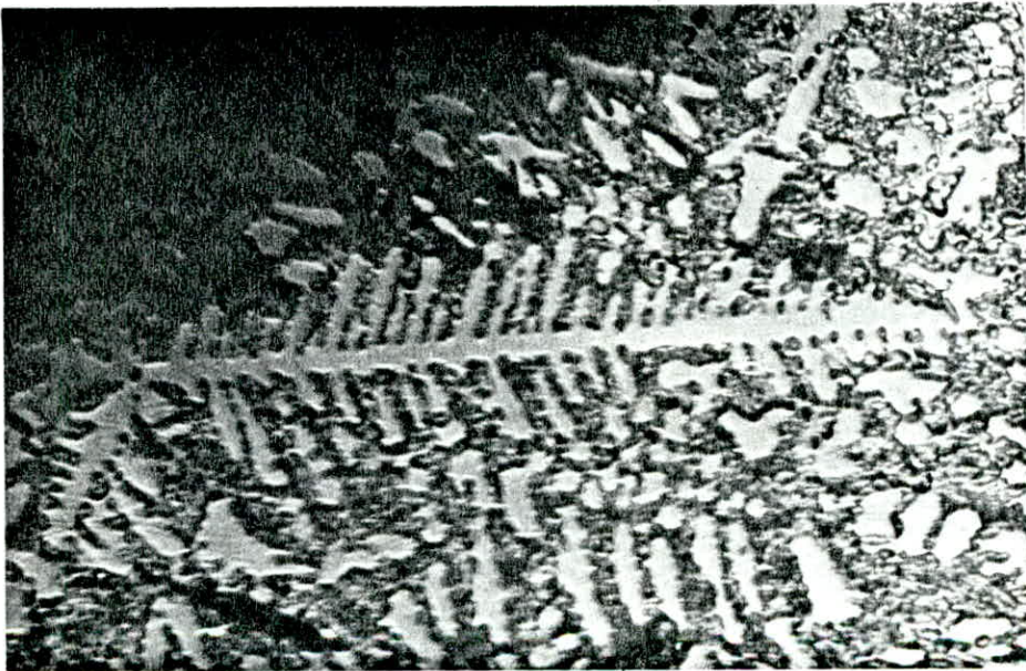
fig 15 Zamak : 3 - Trempé à eau (G=200)
