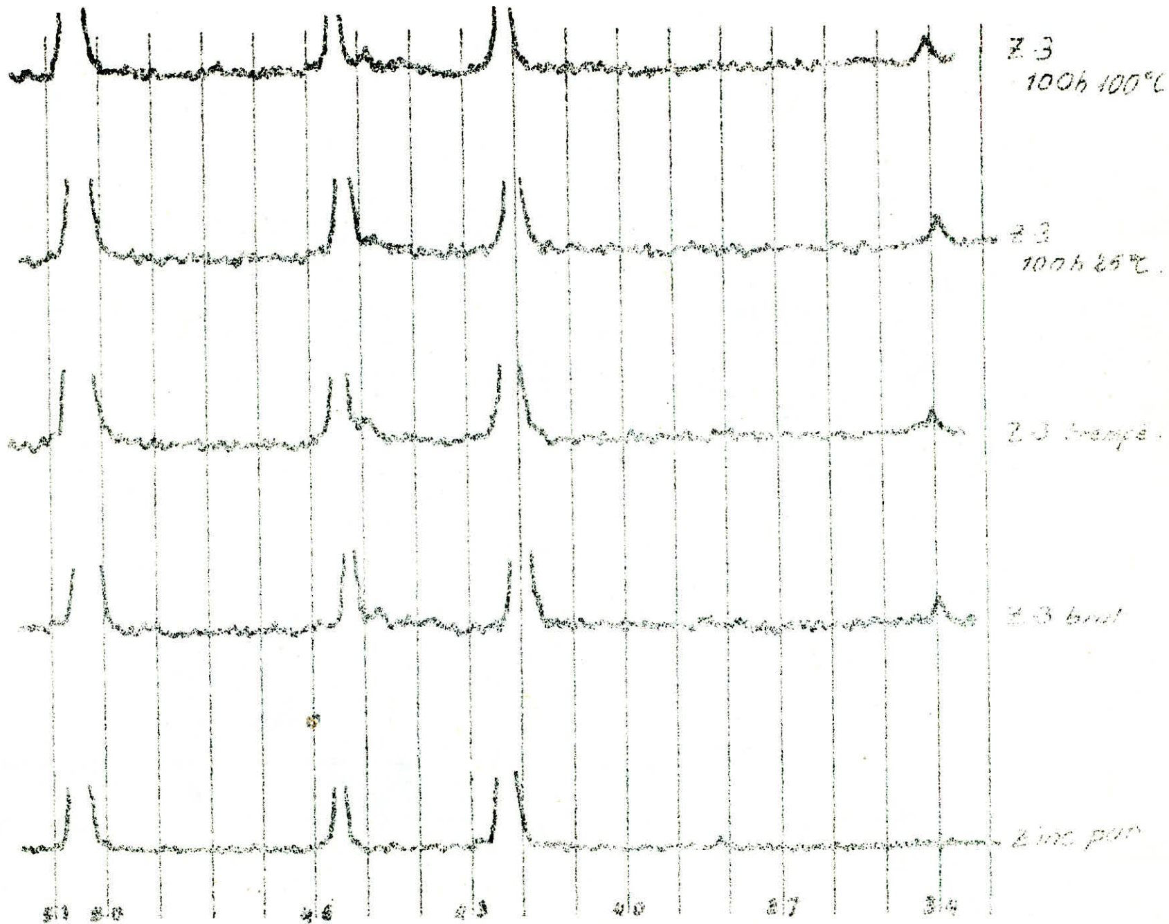
Fig: 20- 2 Reflexion des Zamak: 3 et du Zinc
