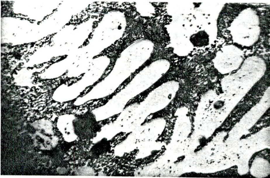
fig 11-2 Zamak: 5 - Brut de coulée (G = 500)
