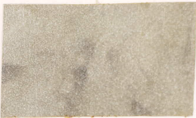
fig. 29 - échantillon trempé - G = 1600.
