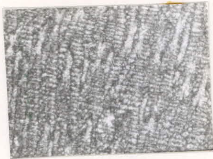
Pb - Cu (0,043%) - Sb (0,77%) X 25 structure dendritique fine de Pb (Blanc) attaqué au: molybdate d'ammonium + acide nitrique
