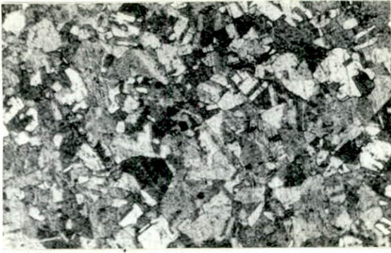
Fig 5.1 : fil machine brut de coulée continue coupe longitudinale x175
