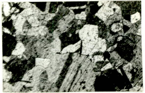
Fig 5.2 : fil machine de coulée continue coupe en travers x175
