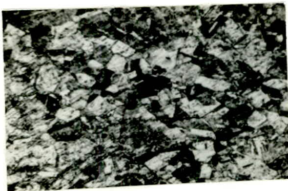
Fig 5.5 : fil de coulée continue après une réduction de section de 16 % coupe en long x 175
