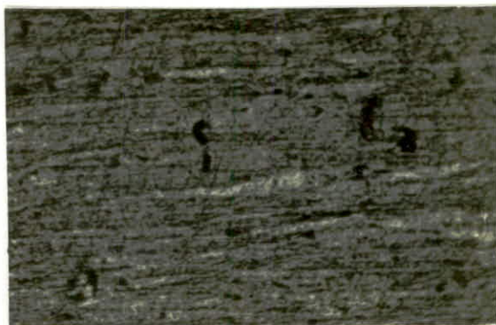
Fig 5.9 : fil classique après une réduction de section de 80 % coupe en long x 175
