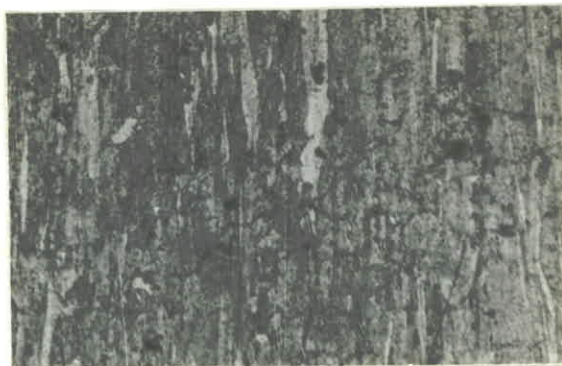
Fig 5.8 : fil de coulée continue après une réduction de section de 80 % coupe en long x 175
