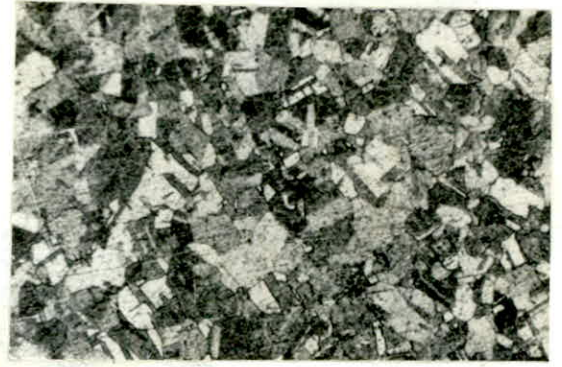
Fig 5.2 : fil machine de coulée continue coupe en travers x175
