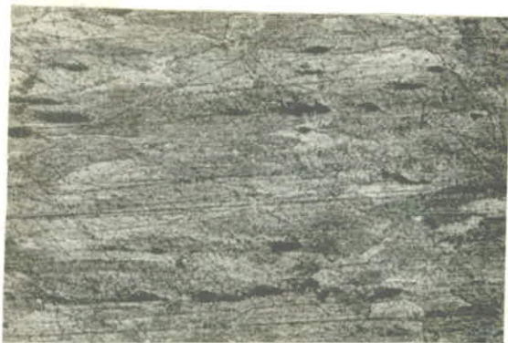
Fig 5.7 : fil classique après une réduction de section de 49 % coupe en long x 175
