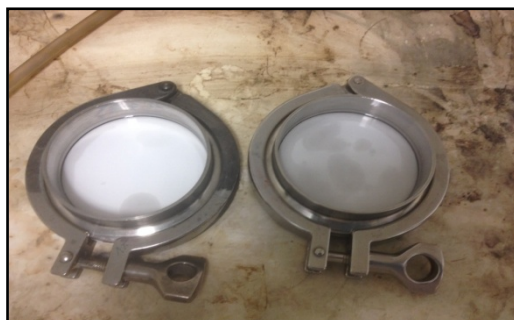
Figure III.2 : Les supports métalliques utilisés pour la modification de surface
