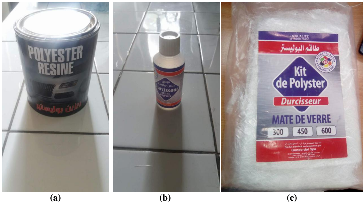
Figure 2.2 : (a) Résine utilisée pour la fabrication des composites, (b) Durcisseur, (c) Fibre de verre
