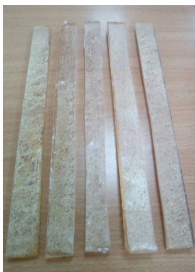
Figure 2.11 : Les éprouvettes de l'essai de traction
