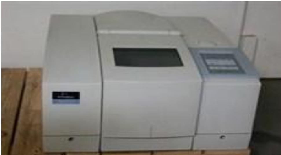
Figure 2.7 : Spectromètre FTIR (Spectrum One)
