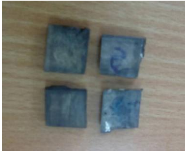
Figure 2.9 : La métallisation des échantillons au carbone
