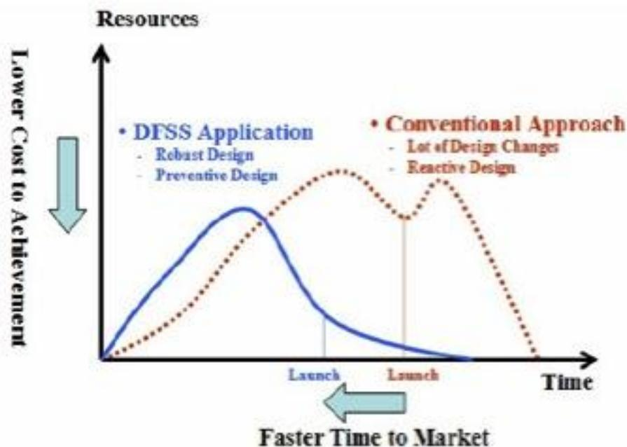
Figure I.2. Optimisation des ressources et du temps de la méthode Design For Six Sigma (DFSS) [13].
