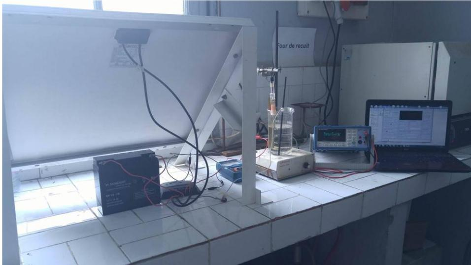
Figure II.3 Dispositif de la protection cathodique par courant imposé.
