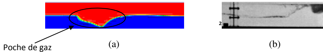
Figure 5.4. (a) Identification de l'écoulement bouchon ; (b) observations expérimentales de vallée et al. 2008.
