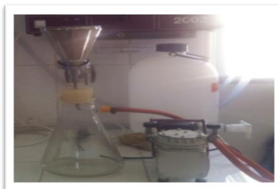
Figure IV.19 : Pompe de filtration.[9]
