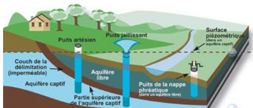
Figure 1. 6 Schémas récapitulatif des types de nappes [43]
