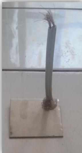
**Figure 4.2 :** *Electrode composée de plaque en acier, fil électrique et silicone.*
