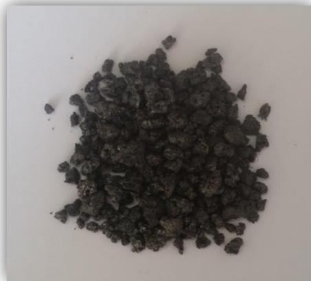
**Figure 4.3 :** *Granules de graphite utilisés lors de l'expérience.*
