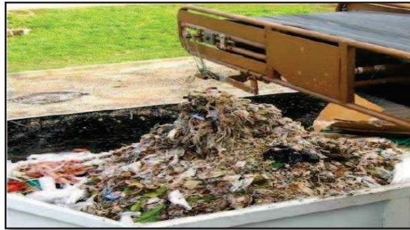
Figure V.3: Refus de dégrillage
