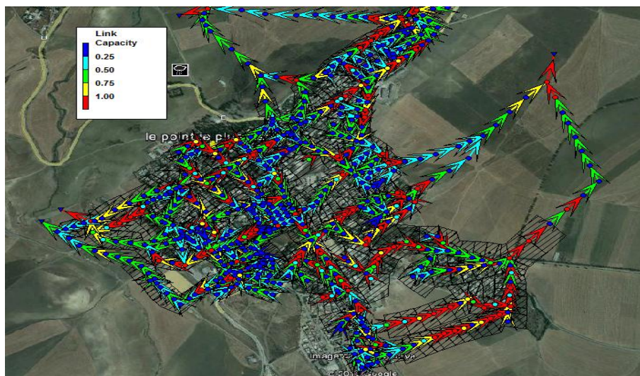
Figure V.23 : Capacité maximale du réseau pour P=30 ans pendant l'heure de pointe.
