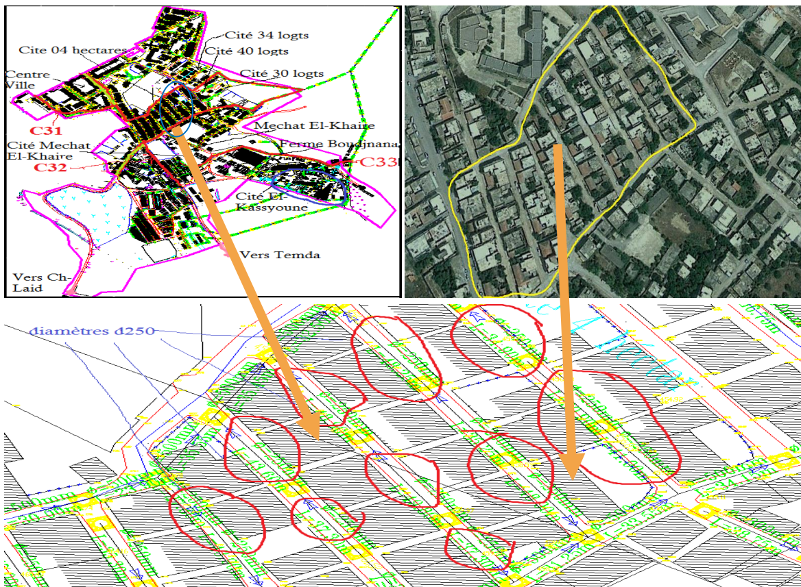
Figure III.13 : Conduites sous dimensionnées de \Phi 250 dans la cité des 04 hectares.
