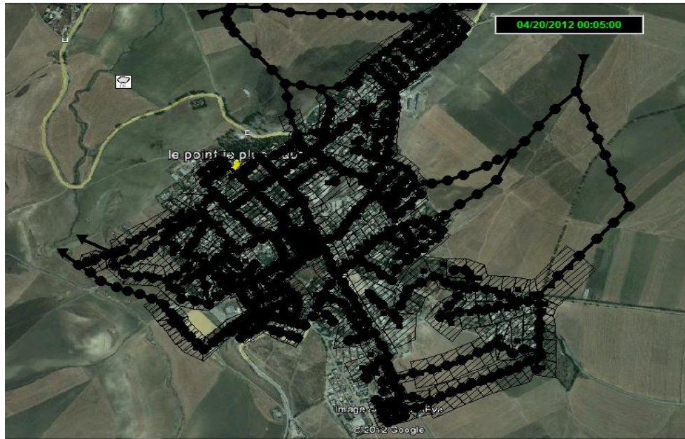
Figure V.03 : Visualisation du réseau d'assainissement de la ville d'AHMED RACHDI modélisé sous SWMM5.
