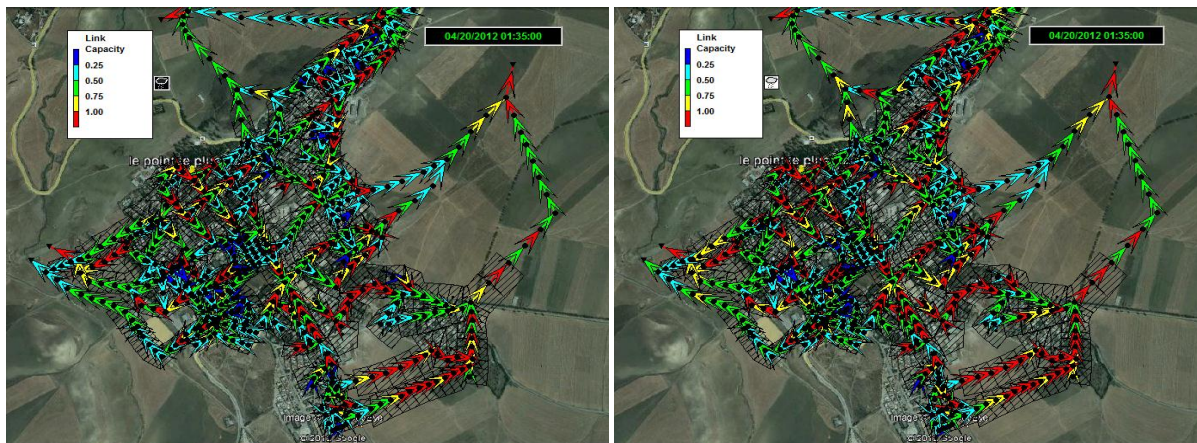
Figure V.29 : la capacité maximale du réseau (la pluie décennale à gauche, la pluie trentenaire à droite).
