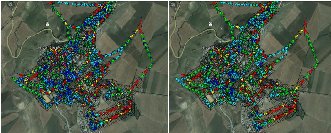
Figure V.30 : Capacités hydrauliques du réseau ( k=75 \text{ m}^{1/3}/\text{s} (à gauche), k=67.5 \text{ m}^{1/3}/\text{s} (à droite)) à l'heure de pointe.
