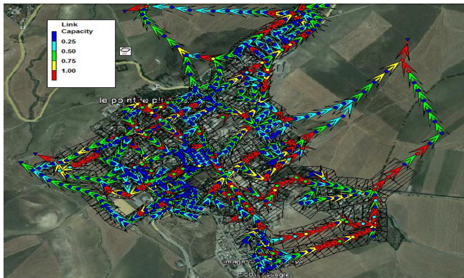
Figure V.22 : Capacité maximale du réseau pour P=20 ans pendant l'heure de pointe.
