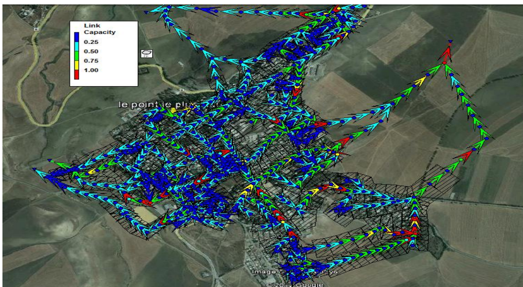
Figure V.18 : Capacité maximale du réseau lors l'heure de pointe.
