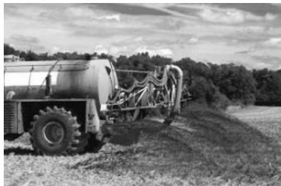
Figure III. 1: L'épandage des boues liquides réalisé par le biais de lisier.
