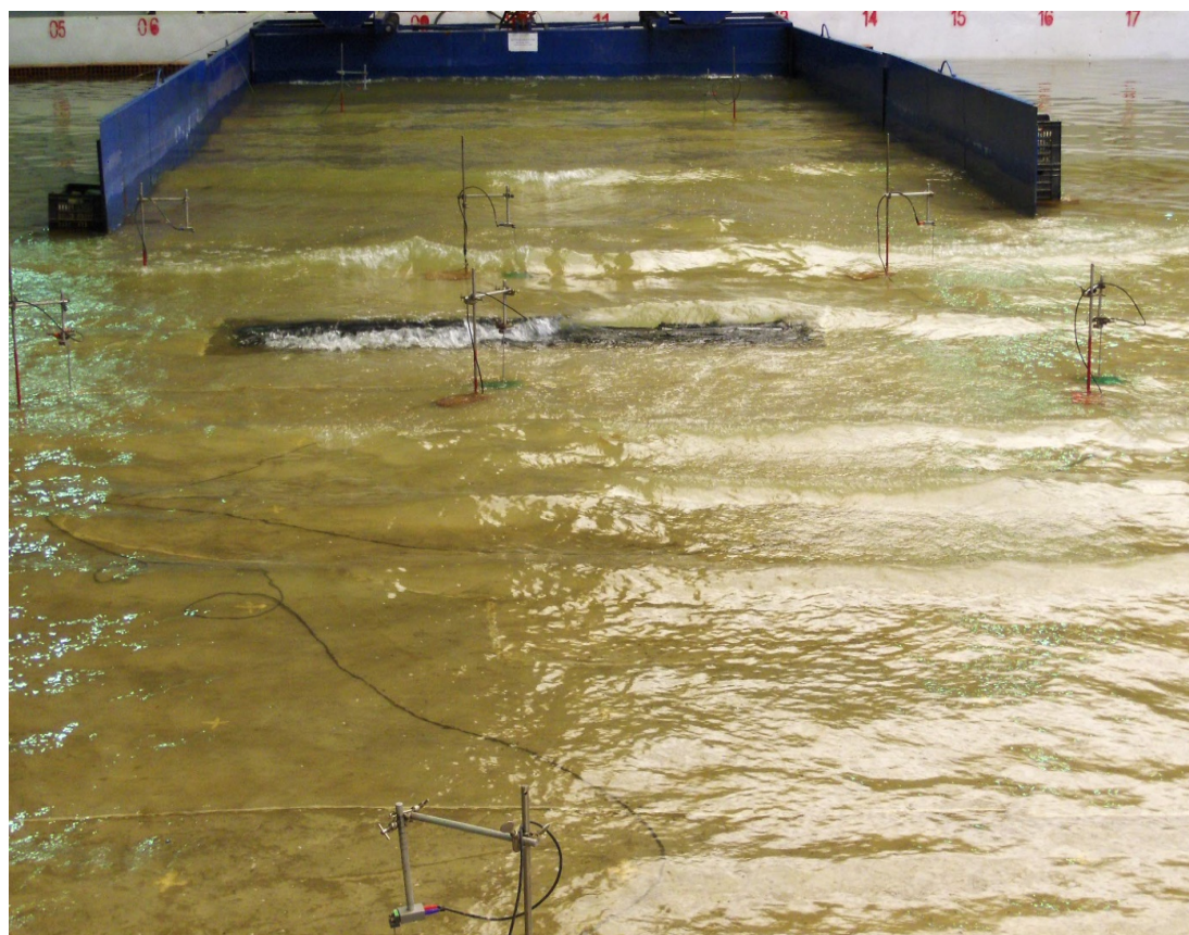
Vue générale du batteur de houle et des guideaux utilisés en bassin à houle
