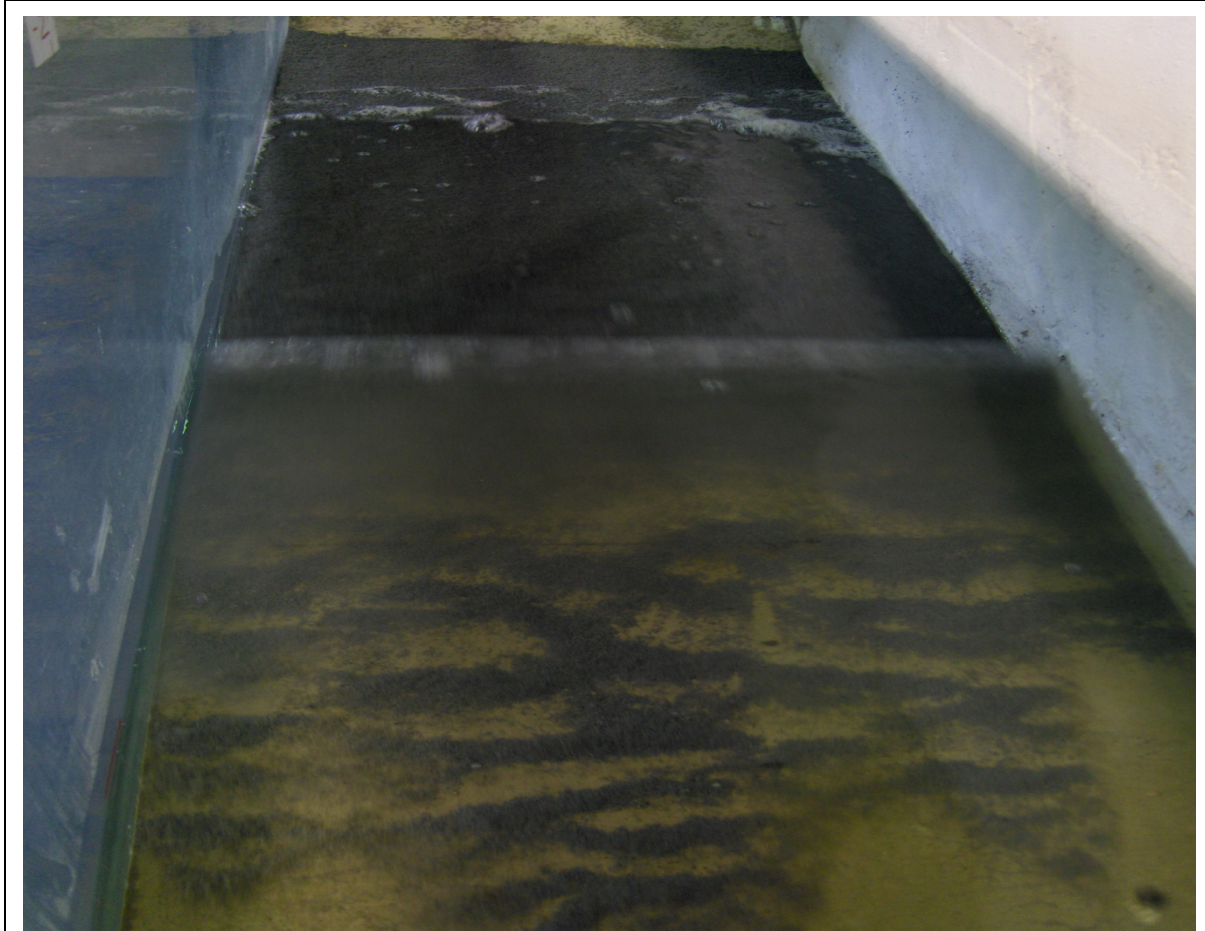
Rechargement de la plage en canal à houle
