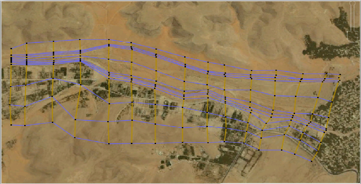
Figure VI-3 : Maillage initial généré par le logiciel Fudaa- modeleur
