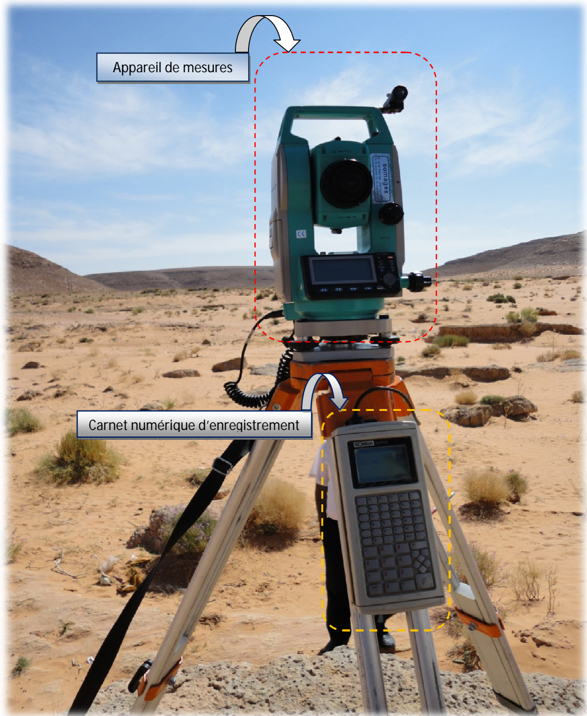
Photo IV-2 : Appareil de mesures avec Carnet numérique d'enregistrement automatique des points
